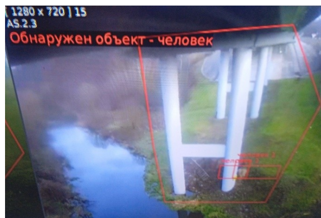
Рисунок 3 – Сбой при испытании отечественной ИИ-системы комплексной охраны объекта критической инфраструктуры
