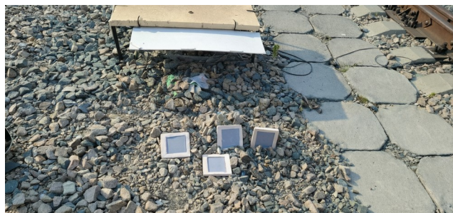
Рисунок 1 – Измерение температуры образцов скального грунта на учебном полигоне СГУПС
